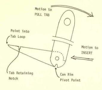
FIGURE 4. BEVERAGE CAN TAB PULLER
